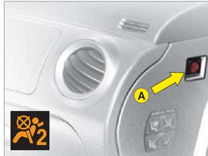
1. Bei ausgeschalteter Zündung den Schlüssel in den Kontaktschalter **A** einführen.
