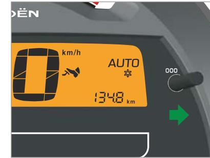
Der eingelegte Gang und der Modus «**AUTO**» werden am Kombiinstrument angezeigt.
