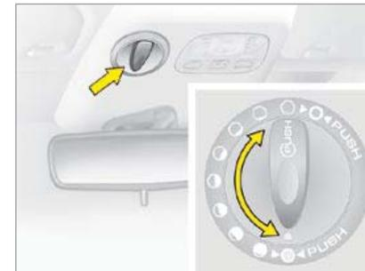
Die Betätigung nach links drehen, um das Faltdach zu öffnen.
