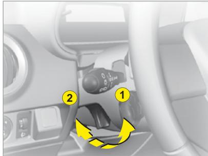
1. Entriegelung durch Ziehen des Hebels
