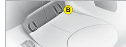
Zwei Ringe **B** zwischen der Rückenlehne und der Sitzfläche des Fahrzeugsitzes ermöglichen die Befestigung eines Kindersitzes.
