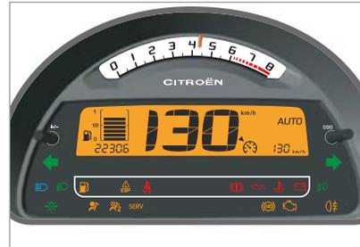
Bei eingeschalteter Zündung werden die orangefarbenen und roten Warnleuchte eingeschaltet.
