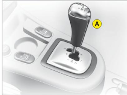
Dieses automatisierte 5-Gang-Schaltgetriebe bietet je nach Wunsch den Komfort der Automatikschaltung oder das Vergnügen des manuellen Schaltens der Gänge.
