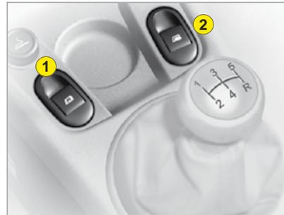
1. Betätigung des elektrischen Fensterhebers auf der Fahrerseite
